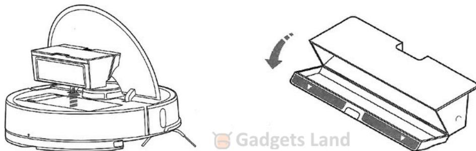
2. Наполните пылесборник небольшим количеством воды, закройте его и встряхните. После этого вылейте грязную воду, повторите процедуру еще раз. Теперь ваш фильтр чистый.
