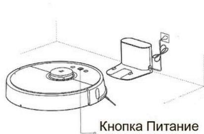
Нажмите и удерживайте кнопку Питание, чтобы включить устройство. Дождитесь пока включится кольцеобразный индикатор, после чего можно подключать устройство к док-станции на подзарядку.
