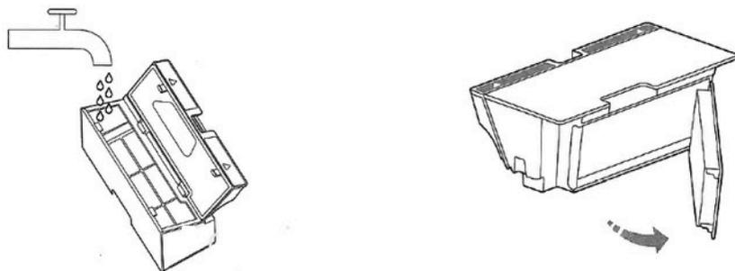
Нажмите на фиксатор, чтобы снять фильтр.
