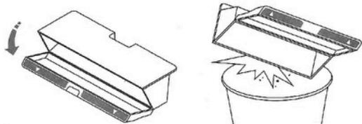
1. Откройте основную верхнюю панель пылесоса, зажмите фиксаторы и извлеките пылесборник.
