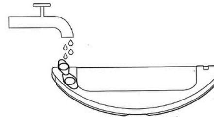
2. Заполнение емкости для воды: откройте крышку резервуара для воды, заполните ее водой и закройте крышку.
